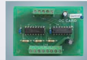
OC-CARD(差動/OC変換基板)
