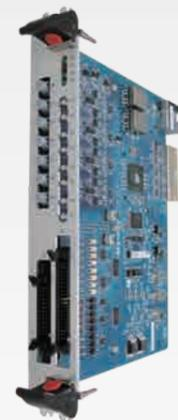
FPGAを搭載し、ゲート信号出力を三相分 (6ch/24ch) 備えたボードです。従来のFPGAボードと比較し、最新のFPGA (Xilinx社製 Kintex-7® スピードグレード1) を搭載。当社が独自に提供するIP (Intellectual Property) を組み合わせることで、FPGAのロジック開発を簡素化します。
