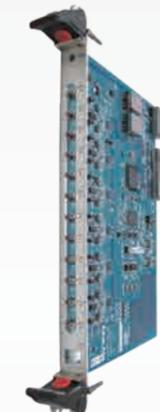
METERボードは、PE-ViewXの電力計測機能(PE-Meter)を使用するための専用ボードです。
