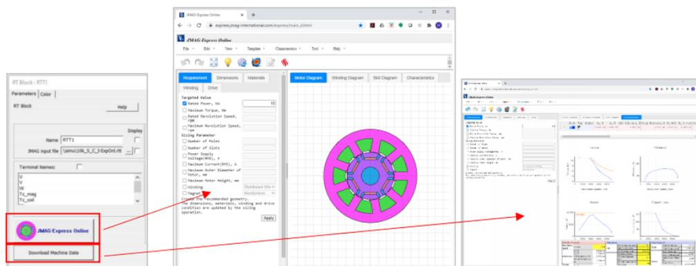
JMAG-Express Online はモータパラメータと基本的なモータ特性を提供します。JMAG-Express Online の大きなメリットは、設計から JMAG-RT モデルを生成できることです。この JMAG-RT モデルを PSIM でモータ駆動システムに利用することができます。
