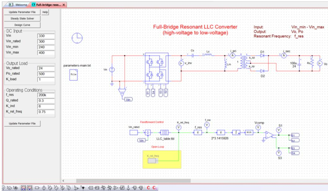
デザインシートは Steady State Solver Tool (次図左側) と Design Curve Tool (次図右側) があり、主要な設計変数のクローズド・フォーム解を提供し、波形を瞬時に表示することができます。これらのツールを使用すると、さまざまな設計シナリオを検討し、設計プロセスを迅速に反復して最適な設計を得ることができます。
