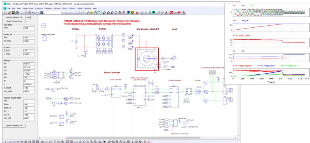
この設定の場合、PMSM は JMAG-RT モデルで表現されています。非線形でモータ電流の関数である  $L_d$  と  $L_q$  の値は JMAG-RT モデルから読み込まれ、モータの非線形制御で使用されます。モータの銅損、鉄損は JMAG-RT モデルから求めることができます。
