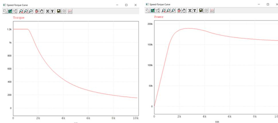
Speed-Torque Curve はドライブシステムの動作境界を素早く判断し、動作条件の適正な定義と制御ループ設計に役立ちます。
