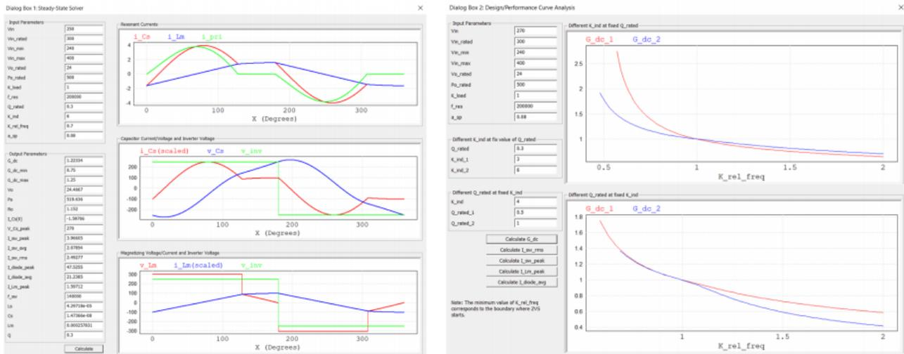
また、フィードフォワード制御のためのルックアップテーブルが自動的に生成されるため、電源や負荷の条件が異なる場合でも共振周波数係数が所望の値に近い値で動作します。
