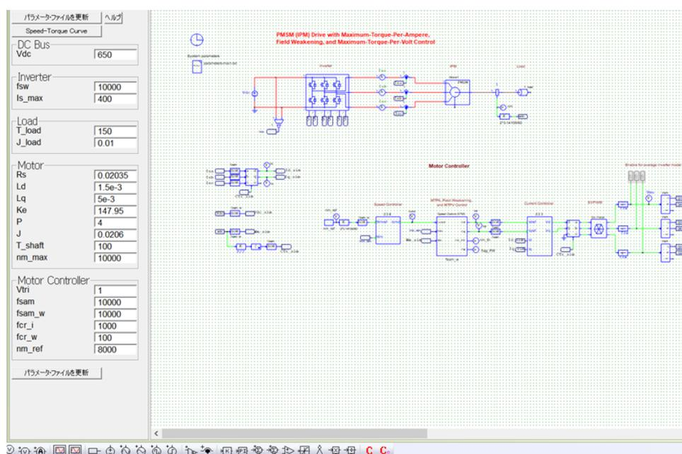
新規追加された Speed - Torque Curve Tool によりシステムのセットアップ前にモータドライブシステムのトルクカーブやスピードをプロットできます。dc バス電圧、インバータ電流、モータパラメータだけでツールは次図のように Speed-Torque カーブを生成します。
