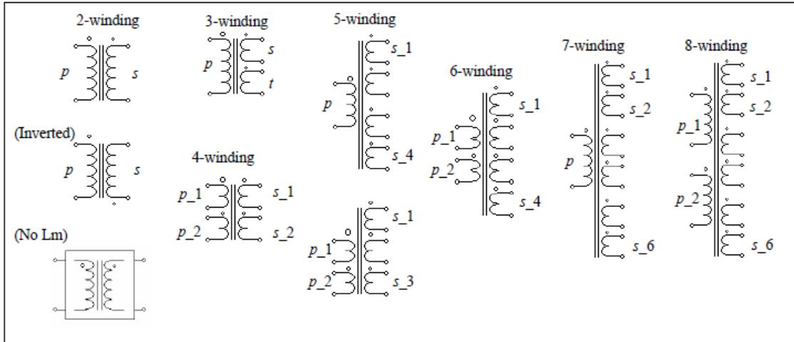
シンボルでは、pは一次側を、sは二次側を、tは三次側を表します。大きなドットの付いた巻線が一次巻線を表します。多巻線変圧器については、巻線の順番は上から下に数えます。2または3巻線変圧器についての仕様は以下のようになります。
