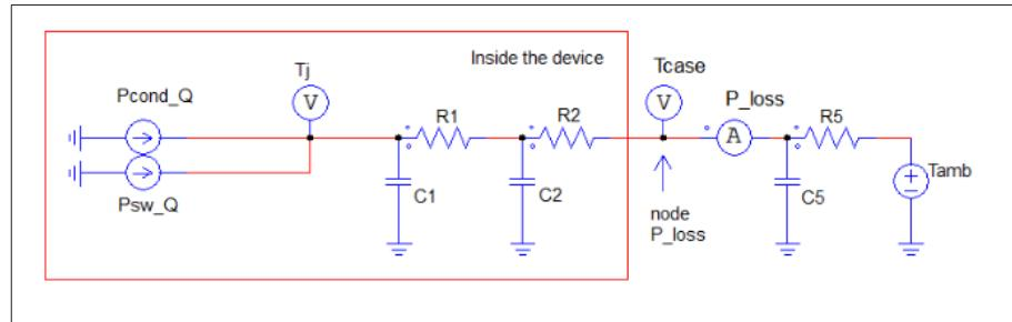
前図の回路中の損失ノード  $P_{cond\_Q}$  の電圧は算出されたトランジスタのジャンクション温度  $T_j$  を表示します。このジャンクション温度はデータベースの曲線が損失計算に使用される時に使用されます。ノード  $P_{loss}$  の電圧  $T_{case}$  はデバイスのケース温度を表しています。デバイスが内部熱回路を持たない場合は  $T_j$  は  $T_{case}$  と同じになるので、外部に熱等価回路を構築する必要があります。
