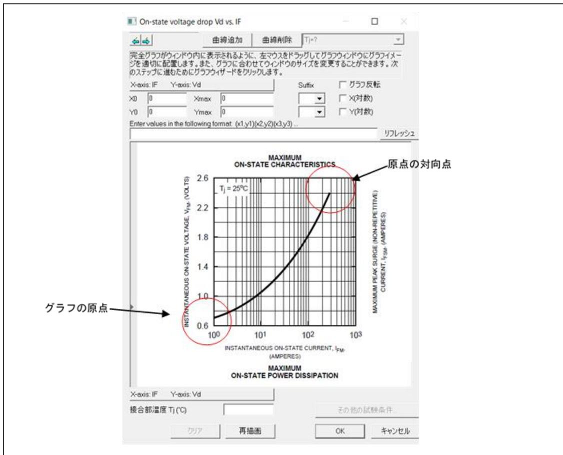
—このステップでは、グラフ領域の境界を定義します。グラフの原点(通常左下隅)でマウスの左ボタンをクリックし、原点の反対の角(通常右上隅)でマウスの左ボタンをクリックします。グラフの原点が左下隅でなく各コーナーのうちのいずれか1つである場合もあります。—グラフ原点の位置をより正確に見つけるために、マウスの右ボタンをクリックして拡大してください。ズームを解除するためには、Esc(Escape)キーを押してください。
