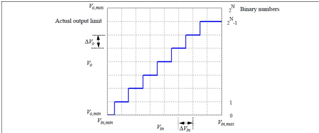
ビット数は出力の分解能を決定します。入力幅  $V_{in,max} - V_{in,min}$  は  $2^N$  ステージに分割されます。各ステージの幅は以下のように表されます。
