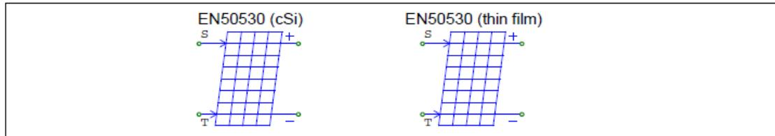
シンボルの "+" と "-" のノードはそれぞれ正と負の端子を表しています。 "S" で示したノードは光強度入力 ( $\text{W}/\text{m}^2$ ) を、 "T" で示したノードは周囲温度入力 ( $^\circ\text{C}$ ) を表します。上部のノードは、この動作条件で与えられる理論上の最大電力 ( $\text{W}$ ) になります。
