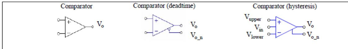
比較器のシンボルはオペアンプのシンボルと似ているので注意してください。比較器では非反転入力は左上で、反転入力が左下になります。オペアンプではこれが逆になります。
