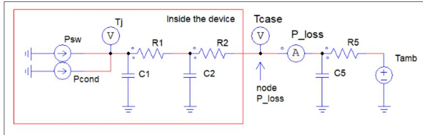
前図の導通損失端子  $P_{cond}$  またはスイッチング損失端子  $P_{sw}$  の電圧は、算出されたダイオードのジャンクション温度  $T_j$  を表し、データベースの曲線から損失を算出する際に使用されます。ノード  $P_{loss}$  の電圧  $T_{case}$  はデバイスのケース温度を表しています。デバイスが内部熱回路を持たない場合は  $T_j$  は  $T_{case}$  となるので、外部に熱等価回路を構築する必要があります。
