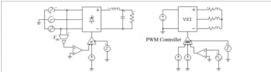
左側のサイリスタの回路は  $\alpha$  コントローラを使用しています。三相回路では電圧  $V_{ac}$  のゼロクロスは遅延角  $\alpha$  がゼロに等しい瞬間にに対応します。この信号はコントローラの同期のために使われます。
