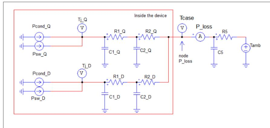
前図の回路中の損失ノード  $P_{cond\_Q}$  と  $P_{cond\_D}$  の電圧は算出されたトランジスタとダイオードのジャンクション温度  $T_{j\_Q}$  と  $T_{j\_D}$  を表示します。これらのジャンクション温度はデータベースの曲線が損失計算に使用される時に使用されます。ノード  $P_{loss}$  の電圧  $T_{case}$  はデバイスのケース温度を表しています。デバイスが内部熱回路を持たない場合は  $T_{j\_Q}$  と  $T_{j\_D}$  は  $T_{case}$  となるので、外部に熱等価回路を構築する必要があります。
