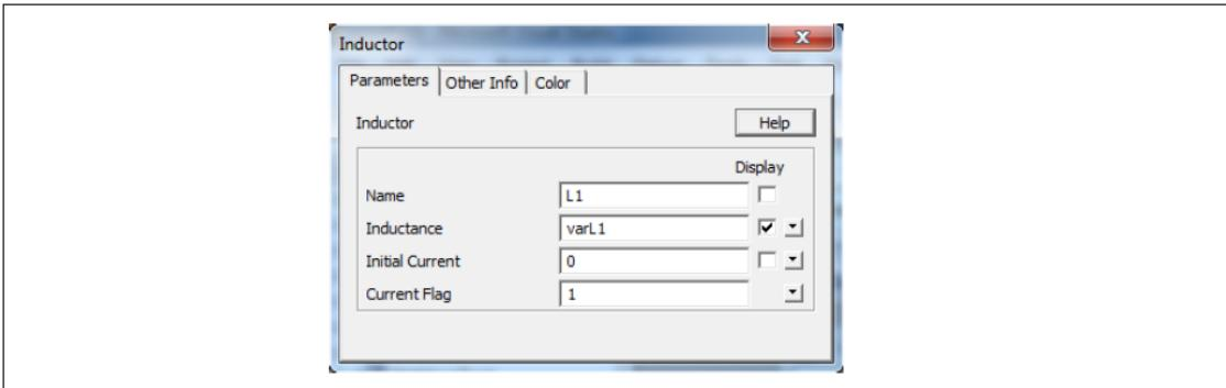
まず Simulink 上で、SimCoupler ブロックをダブルクリックしてプロパティダイアログを開き、"Add Variable"ボタンをクリックします。そして下図のように、リストに新しく追加された行をクリックし、変数名と値を入力します。
