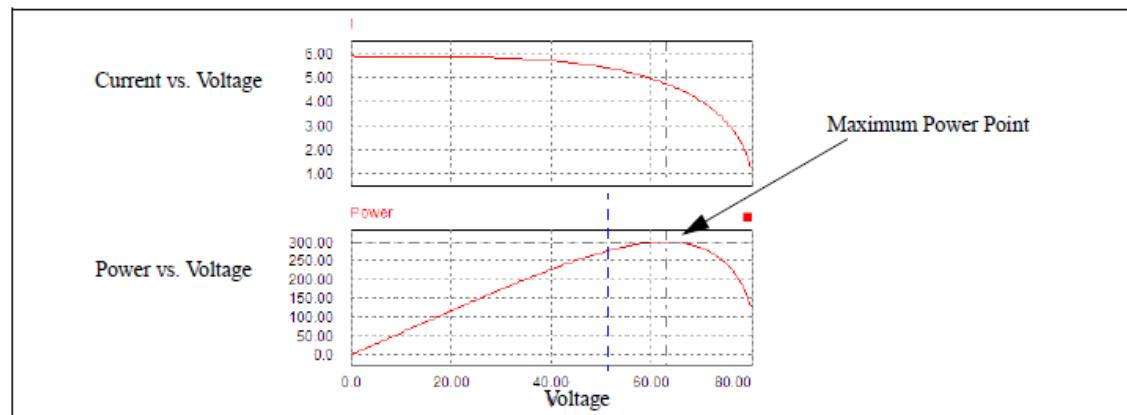
図から、電圧が増加するのに従って太陽電池モジュールの出力電力が増加し、あるポイントで出力電力が最大になることがわかります。様々な運転条件の下で最大出力点(Maximum Power Point Tracking : MPPT)を見つけるために、各種制御方式が提案されています。
