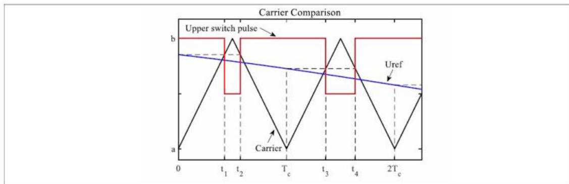
入力信号は前図の  $U_{ref}$  です。このコントローラは入力信号をサンプリングして三角波と比較し、一対のインタロックスイッチのゲート信号を生成します。
