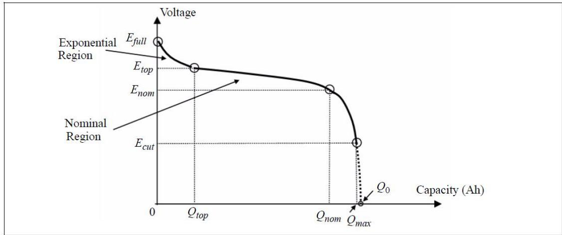
CapacityFactor はほぼ  $Q_0$ ( 0V の時の容量)と  $Q_{max}$  のときの比になります。その値は 1 に近い値でありバッテリ電圧は SOC=0 の時に  $E_{cut}$  に等しくなるように設定する必要があります。
