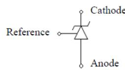
TL431 レギュレータは基準ノードの電圧を約 2.495V に保ちます。このモデルでは、TL431 の有限帯域幅がモデル化されます。すなわち、TL431 モデルの AC 周波数特性はデータシートの図のようになります。
