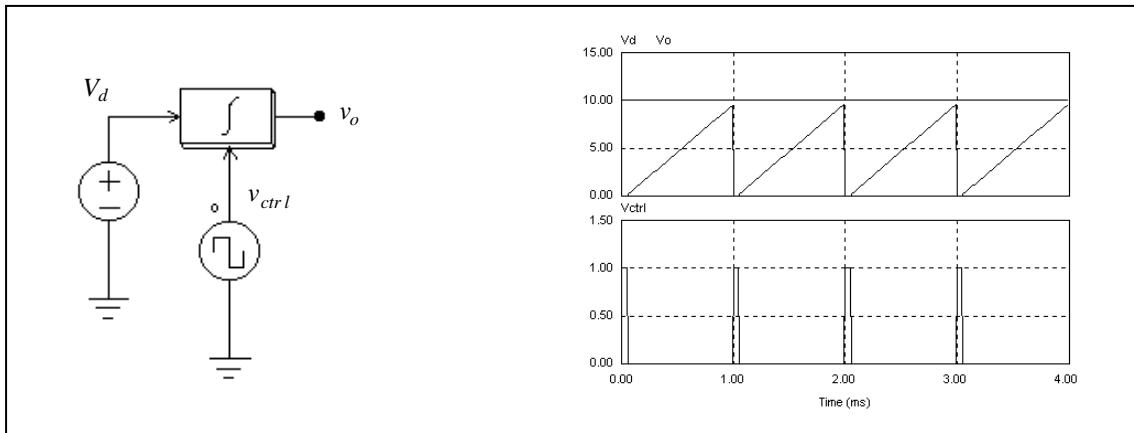
上の図で、積分器の入力は直流です。積分器の制御信号にパルス波形を入力し、積分器の出力を各サイクルの終わりにリセットしています。
