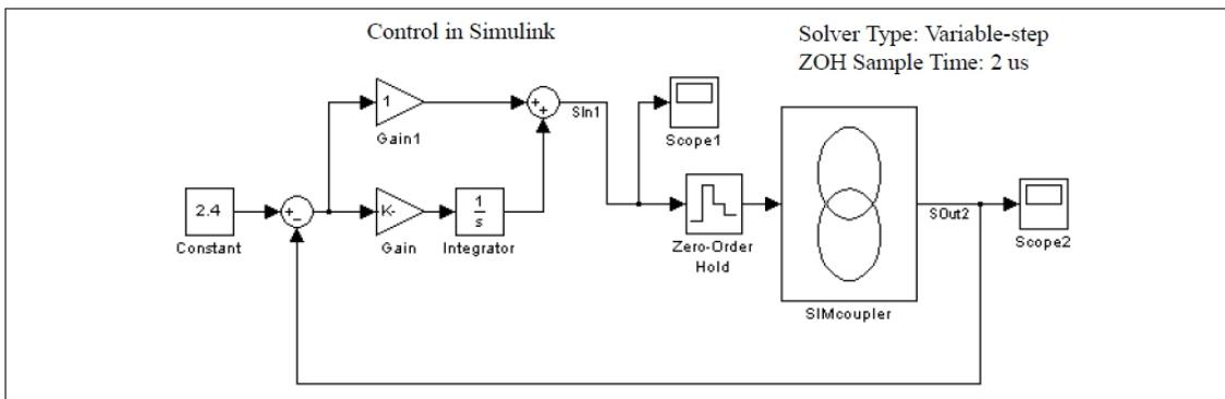
まとめとして、PSIM と MATLAB/Simulink で連成シミュレーションをおこなう場合は、Simulink の Solver Type は **Fixed-step** に設定して、タイムステップを PSIM と同じか、近い値に設定してください。また、Solver Type を **Variable-step** にした場合はゼロ次ホールドを使って、サンプル時間を PSIM のタイムステップと同じに設定するようにしてください。
