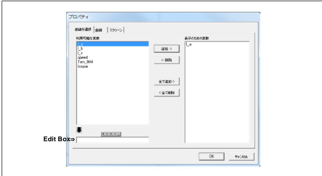
すべての曲線表示可能な変数は、左側の「利用可能な変数」のボックスに一覧表示されます。現在表示中の変数は右側の「表示のための変数」のボックスにリストされています。「利用可能な変数」のボックスで変数をハイライトしてから、[追加->]のボタンを押すと「表示のための変数」のボックスにこの変数が追加されます。同様に、「表示のための変数」ボックスで変数をハイライトして[<-削除]のボタンを押すと、その変数を削除できます。
