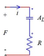
起磁力は、電圧源の形でコンデンサ(静電容量はAL)と抵抗Rの間に印加されます。このブランチを通じて流れる電流をiとし、そのrms値をI<sub>rms</sub>とすると、漏れ磁束の損失と抵抗Rの関係は次のようになります。
