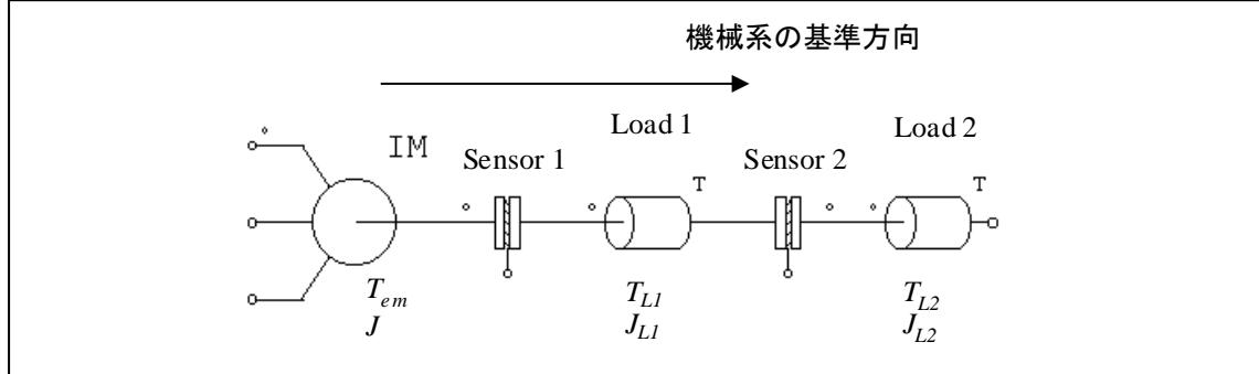
この機械系は 1 つのモータ、2 つのトルクセンサ、2 つの負荷からなります。モータと負荷のトルク( $T$ )と慣性モーメント( $J$ )は図に示すとおりです。基準方向はこの場合、左から右です。この系の運動方程式は次のようになります。
