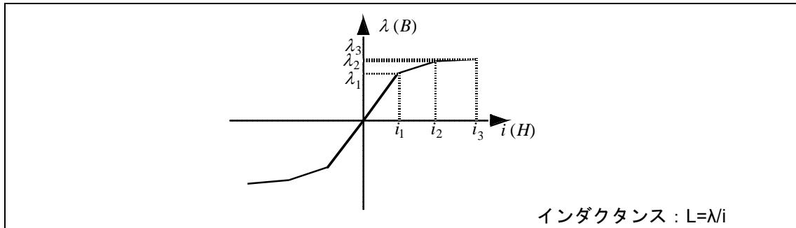
インダクタンスは  $L = \lambda / i$  で求められ、これは  $\lambda - i$  曲線の傾斜に相当します。したがって、飽和特性は異なる点のデータの対を  $(i_1, L_1)$ ,  $(i_2, L_2)$ ,  $(i_3, L_3)$ , などのように指定することにより表現できます。
