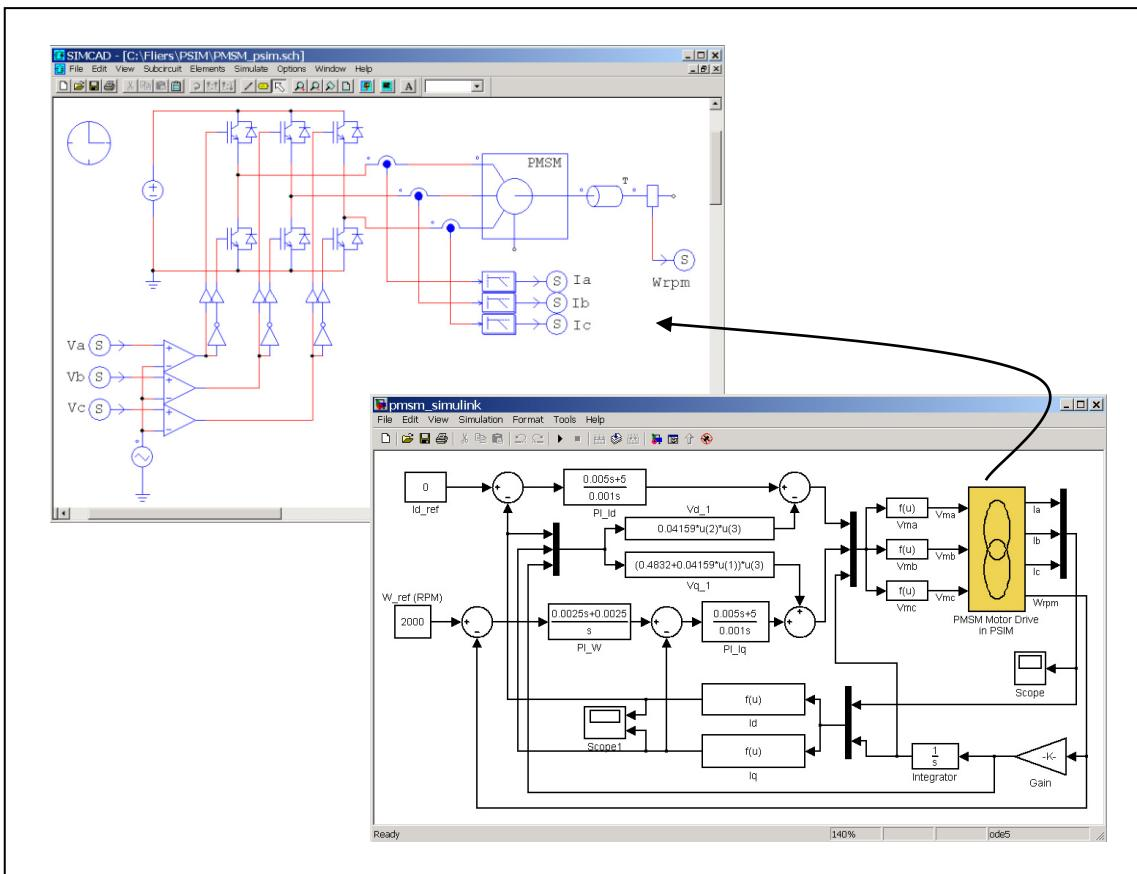
以下にこの例題にもとづいて SimCoupler を使って PSIM と MATLAB/Simulink の連成シミュレーションを構成する手順を説明します。
