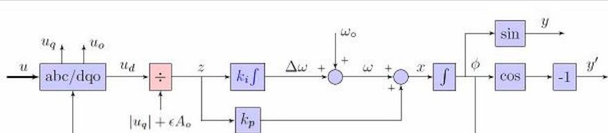
3ph-PLL ブロックは三相平衡もしくはほぼ平衡入力を受け入れます。3ph-ePLL は平衡または非平衡にかかわらず一般的な三相信号を処理します。
