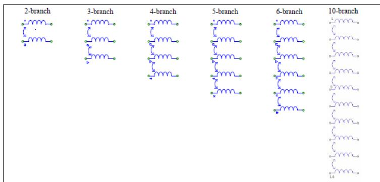
上図シンボルでは、○がインダクタ 1、□が 2、△が 3、+が 4、×が 5、\*が 6、<sup>10</sup>が 10 の入力端子を示します。
