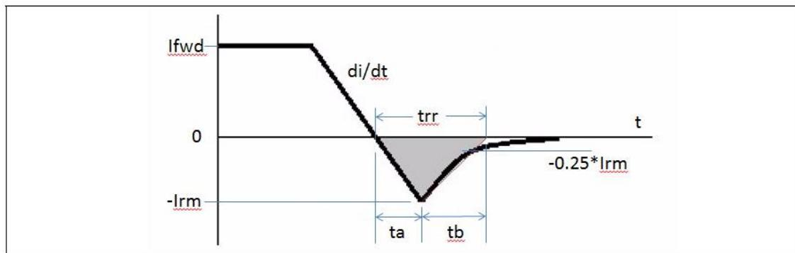
逆回復時間  $trr$  は  $ta$  および  $tb$  に分かれます。 $ta$  の期間では電流値は 0 から  $-I_{rm}$  まで直線的に変化します。 $tb$  は JEDEC(Joint Electron Device Engineering Council)によると、上図のように  $-I_{rm}$  から  $-0.25*I_{rm}$  までの直線が時間軸と交差するまでの期間と定義されています。
