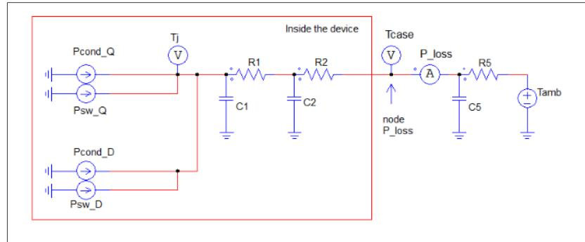
次図はMOSFETで“Separate Rth\_diode”的チェックボックスをチェックした場合の熱回路になります。この場合はトランジスタとダイオードとで個別に内部熱回路とジャンクション温度を持ちます。
