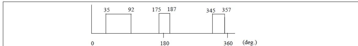
スイッチが 2000Hz で動作し、1周期内で以下のようなゲート・パターンを持つと仮定します。
