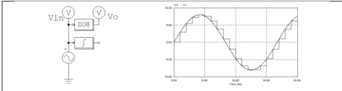
上の回路では入力の正弦波に連続型の積分器が接続されています。このため、この回路は連続・離散混合回路となり、連続系のシミュレーションタイムステップにより計算が行われます。こうしたシミュレーションタイムステップにより、ゼロ次ホールド素子の出力は上に示すように階段状となります。
