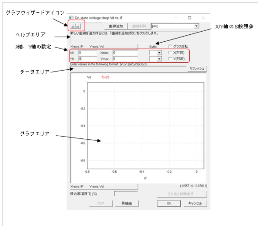
グラフを定義するには2つの方法があります。一つの方法は手動でグラフデータ・ポイントを入力することです。もう一つの方法はグラフィーウィザードを使用し、データシートからグラフを直接得ることです。データポイントが少ない場合は、手動でグラフを定義した方が簡単です。グラフがあるならばグラフィーウィザードを使用するとより簡単にできます。
