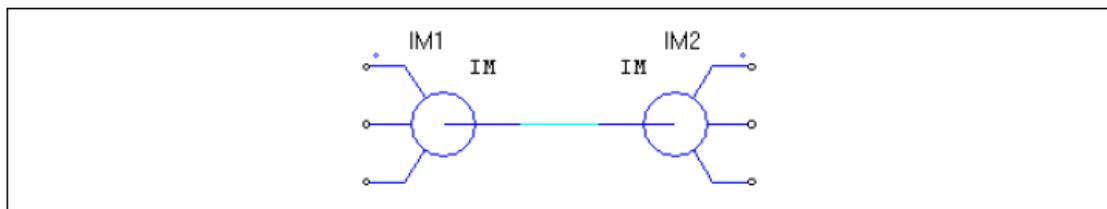
上記システムは2つの誘導機、すなわち結合されたIM1とIM2から構成されます。一方がモータもう一方が発電機として動作します。IM1から見た機械方程式は下記の通り記述されます。
