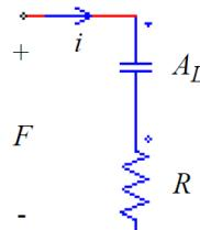
起磁力は、電圧源の形でコンデンサ(静電容量は $A_L$ )と抵抗 $R$ の間に加えられます。インダクタンスファクターは次のように定義されます。
