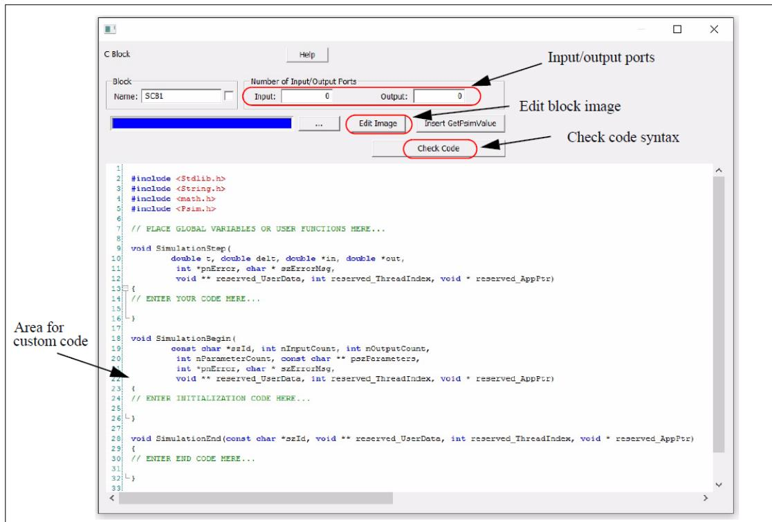
Number of Input/Output Ports セクションでは、入力ポート及び出力ポートの数を定義します。ポートの数を変えた後、回路図でのブロック・図はそれに従って変化します。
