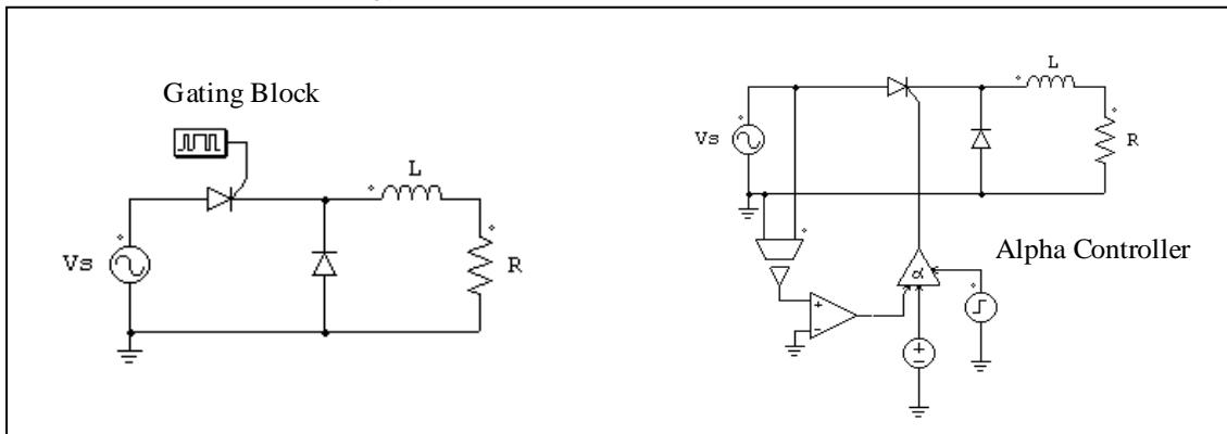
左側の回路はスイッチ・ゲート信号ブロックを使っています。スイッチング・ゲートパターンと周波数はシミュレーション開始前に設定し、シミュレーション中に変化することはありません。右側の回路は点弧角制御器を使っています。遅れ角  $\alpha$ (度)は回路の直流電圧源により指定されます。
