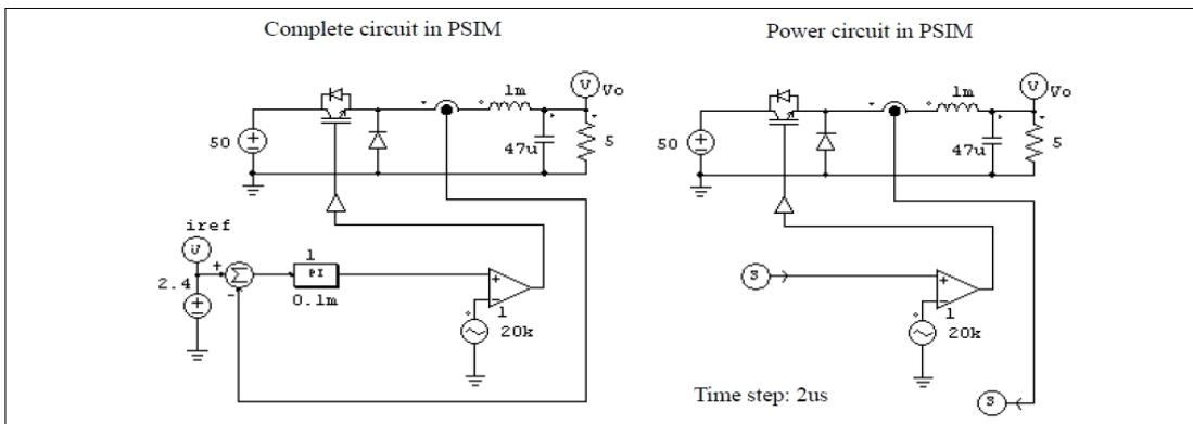
Simulink の設定はいくつか異なる方法があります。推奨の方法は Solver Type を **Fixed-step** に設定して、Fixed step size を PSIM のタイムステップと同じに指定することです。
