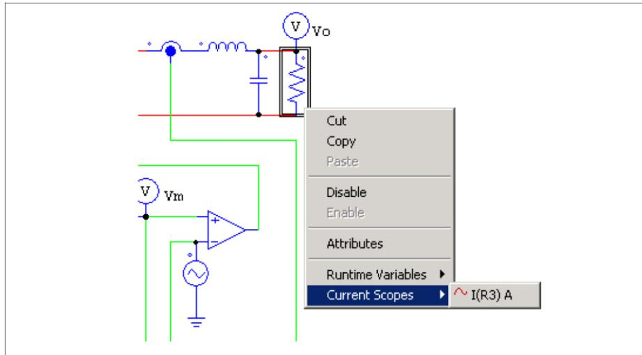
要素がCurrent Scopesメニューの複数の電流フラグを持っていると、複数のブランチ電流が表示されます。それぞれのブランチはそれぞれの電流のフラグに対応するようになります。
