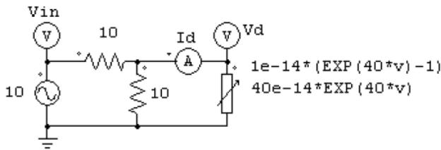
上の回路で、非線形素子(NONI)が非線形ダイオードを模擬しています。ダイオードの電流は電圧の関数で  $i = 10^{-14} \cdot (e^{40v} - 1)$  と与えています。
