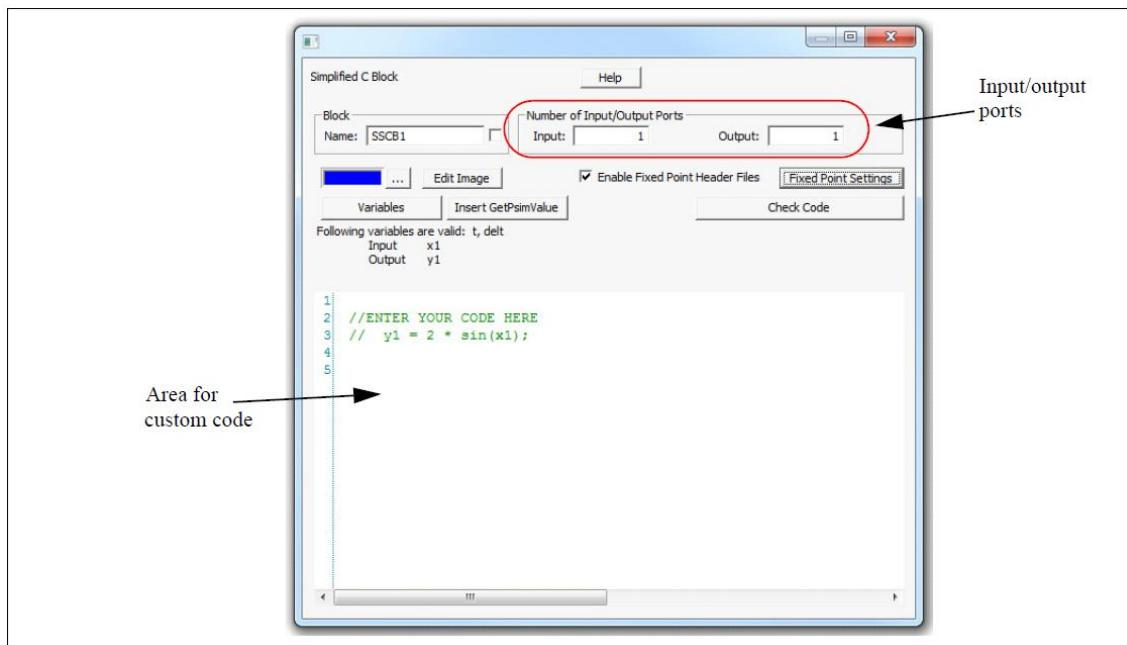
*Number of Input/Output Ports* セクションでは、入出力ポートの数を定義します。ポートの数を変えると、シンプル C ブロックのイメージはそれに従って変わります。
