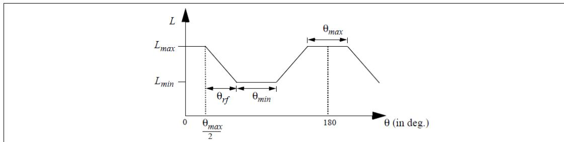
回転角は、固定子と回転子の歯が完全にかみ合っている場合を  $\theta = 0$  とします。インダクタンスの値は、上昇(rising)、頂上(flat-top)、降下(falling)、底(flat-bottom)の 4 段階のいずれかになります。
