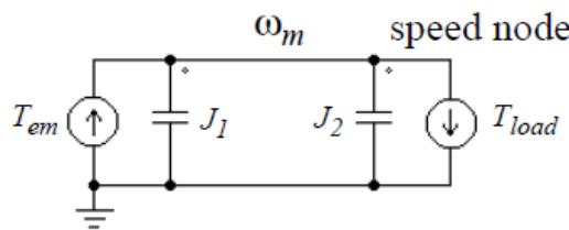
この回路では、2つの電流源を  $T_{em}$  と  $T_{load}$  の値に設定し、キャパシタで  $J_1$  と  $J_2$  を表現しています。また、ノード対地電圧(速度ノード電圧)は機械系の回転速度  $\omega_m$  に対応します。これは  $C = J_1 + J_2, V = \omega_m, i = T_{em} - T_{load}$  とすればキャパシタの方程式  $C^* dV/dt = i$  に等価です。
