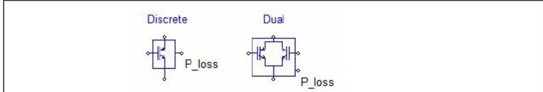
パラメータでは、IGBT ターミナルノードの横に余分なノードがあります。トランジスタ導通損失ノード Pcond\_Q (丸付きのノード)、およびトランジスタスイッチング損失ノード Psw\_Q です。
