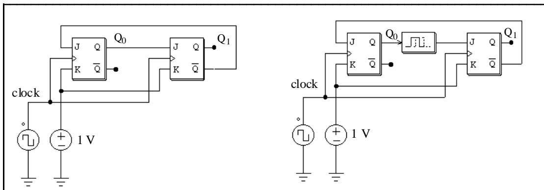
上の回路では、初期値  $Q_0$  と  $Q_1$  はいずれも零と仮定しています。クロックの立ち上がりにおいて、 $Q_0$  は 0 から 1 に状態変化します。伝搬遅れなしとすると、 $Q_1$  は  $Q_0$  と一緒に 1 に切り替わってしまいます。これを防ぐために、右の回路では 1 タイムステップの時間遅れを持つ時間遅れ要素を  $Q_0$  と次のフリップフロップの入力(J)間に追加しています。
