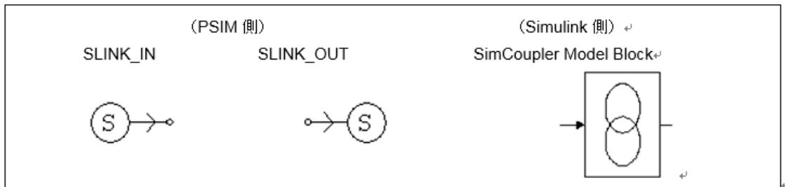
PSIM内では、SLINK\_INのノードがSimulinkからの信号を受け取ります。またSLINK\_OUTのノードからSimulinkへ信号を送ります。これらはいずれも制御素子なので、PSIMの制御回路内でのみ使用可能です。Simulink内では、SimCouplerブロックの入出力端子を経由して他のSimulink内のシステムと接続することができます。
