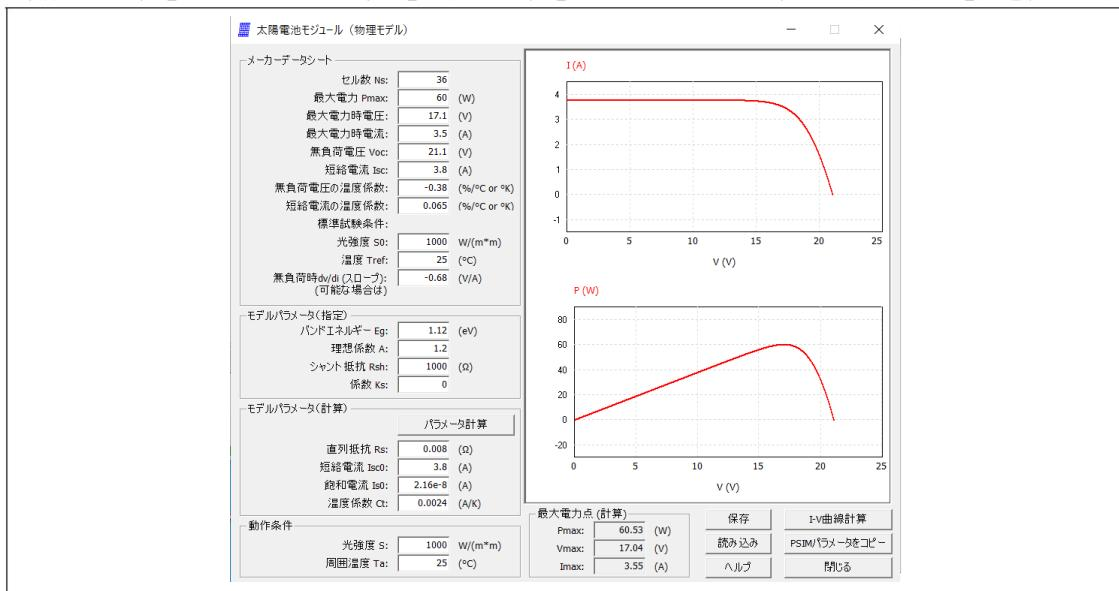
詳細モデルのパラメータの一部はデータシートから得ることができます、残りは実験データから決定します。詳細モデルのパラメータをデータシートから得るためのツールとして、Utilities メニュー内に Solar Cell (Physical Model)が用意されています。
