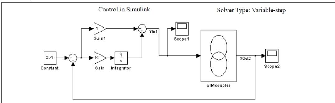
Simulink のタイムステップは PSIM と同一であることを推奨しますが、Simulink の側のタイムステップがわずかに PSIM のタイムステップよりも長い場合にも、充分な精度でシミュレーション結果が得られることがわかっています。上の例では、Simulink のタイムステップは PSIM よりも 10 倍も長い 20μs になっています。
