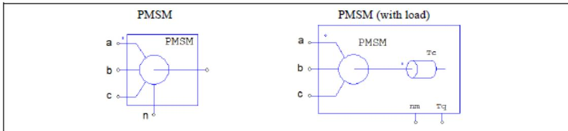
PMSM（負荷あり）には、さまざまなタイプの負荷を選択することができます。ノード **nm** は、機械的速度 (rpm) を提供する制御ノードです。ノード **Tq** は、トルクセンサ出力 (N \* m) を提供する制御ノードです。トルクセンサは機械と負荷の間に配置されています。負荷パラメータの定義については、各負荷の help を参照してください。
