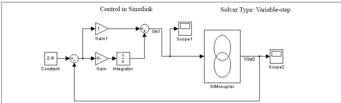
Simulink の Solver Type を **Variable-step** に設定した場合は、正しい結果を得るには SimCoupler の入力にゼロ次ホールドを使う必要があります。さらに、ゼロ次ホールドのサンプル時間は PSIM のタイムステップと同じに設定する必要があります。
