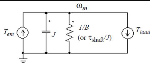
この回路は、軸の時定数T<sub>shaft</sub>が抵抗1/BとキャパシタJによるRC時定数と等しいことを示します。したがって、軸の時定数は以下の試験によって測定することができます。
