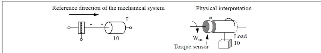
トルクセンサが機械系の等価回路でどのようにモデリングされるかを、以下の図を使って説明します。
