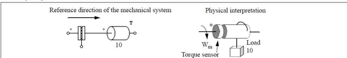
同様に、ドット側が接続されているとき、センサはドット側のトルク強度を計測し、回転速度方向は正方向となります。例として、以下の図のように左右が反転しているトルクセンサを考えます。ドット側が接
