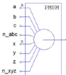
以下に示すように、六相 PMSM の場合固定子巻線は、空間的に 30° シフトされた 2 つの三相巻線で構成されます。三相固定子巻線の各セットは Y 結線されています。
