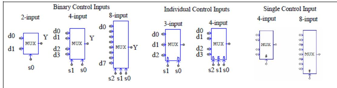
シンボル図で、 $d0 \dots d7$  はデータ入力であり、 $s0 \dots s2$  は制御入力です。マルチプレクサの真理値表は以下のとおりです。
