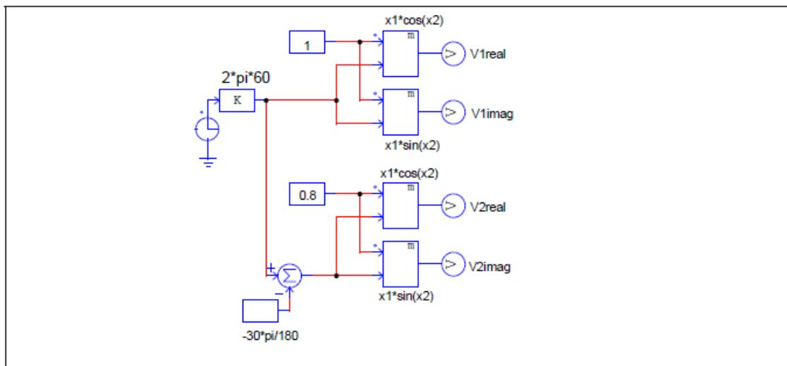
この回路の場合  $V_1$  と  $V_2$  が実部と虚部としてあります。 $V_1$  の Amplitude は 1、 $V_2$  は 0.8 でベクトル  $V_2$  は  $V_1$  に対して  $30^\circ$  ずれています。
