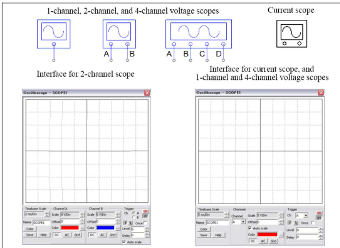
1チャンネル電圧スコープ、4チャンネル電圧スコープと電流スコープの波形表示ウィンドウの下に表示される操作パネルは同一です。4チャンネルスコープでは、チャンネルはドロップダウンリストから選択することができ、設定は選択されたチャンネルに反映されます。
