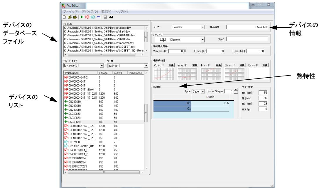
左側には、データベーススタヘロードされるデバイスデータベースファイルおよびデバイスのリストがあります。デバイスはデバイスのタイプかメーカーのいずれかに基づいて表示することができます。さらに、リストのタイトルバーをクリックすることにより、部品番号、定格電圧あるいは定格電流によってデバイスリストをソートすることができます。
