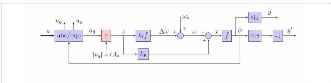
3ph-PLL ブロックは三相平衡もしくはほぼ平衡入力を受け入れます。3ph-ePLL は平衡または非平衡にかかわらず一般的な三相信号を処理します。信号を正シーケンス、負シーケンス、ゼロシーケンスの成分とし
