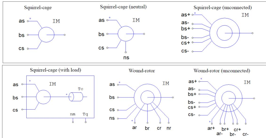
かご形誘導機（負荷付き）のブロックには、さまざまな種類の機械的負荷が含まれています。ノード nm は、機械的速度 (rpm) を提供する制御ノードです。ノード Tq は、トルクセンサ出力 (N \* m) を提供する制御ノードです。トルクセンサは機械と負荷の間に配置されます。負荷パラメータの定義については、各機械負荷を参照してください。
