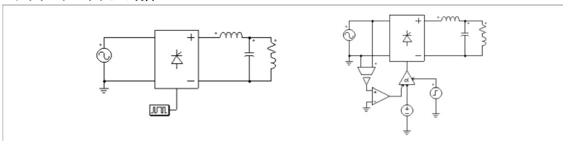
左の回路のゲート信号はゲーティングブロックで設定されます。右の回路のゲート信号は  $\alpha$  コントローラで設定されます。 $\alpha$  コントローラの良い所はサイリスタブリッジの遅延角  $\alpha$  (°) を直接制御できることです。
