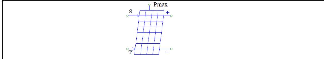
シンボルの "+" と "-" のノードはそれぞれ正と負の端子を表しています。"S" で示したノードは光強度入力 ( $\text{W/m}^2$ ) を、"T" で示したノードは周囲温度入力 ( $^\circ\text{C}$ ) を表します。上部のノードは、この動作条件で与えられる理論上の最大電力 (W) になります。正負端子のノードがパワー回路用なのにに対し、その他のノードはすべて制御回路用になります。
