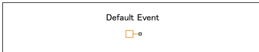
デフォルトイベント素子は、どのサブ回路がデフォルト状態であるかを定義するのに使用され、サブ回路の入力イベントポートに接続されます。
