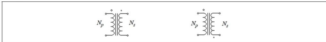
大きなドットの付いた巻線が一次側を表し、もう一方の巻線が二次側を表します。
