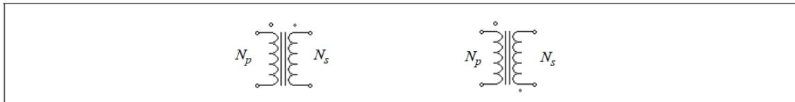
大きなドットの付いた巻線が1次側を表し、もう一方の巻線が2次側を表します。
